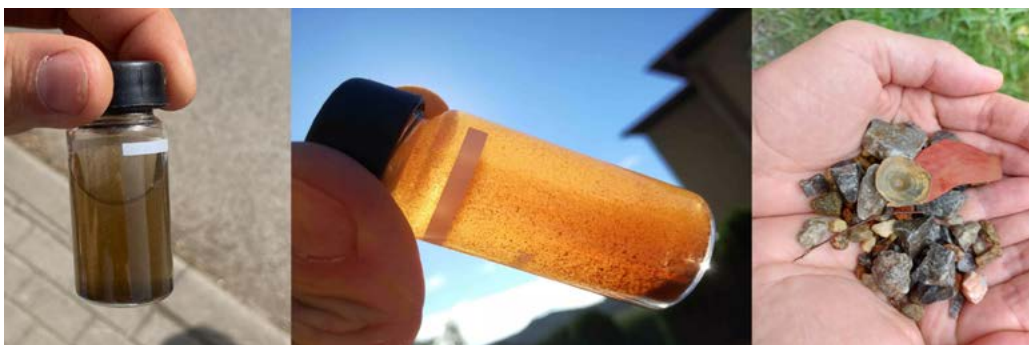
Obr. 2: Vzorky získané během řízeného proplachu potrubí. Černé sraženiny manganu (vlevo); oranžové produkty koroze kovových potrubí (uprostřed); kamínky, plastové špony z navrtávek, různorodé cizí předměty a části korodovaného materiálu kovových potrubí.
