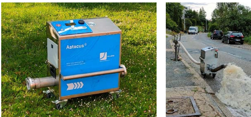
Obr. 3: Technologie Astacus pro čištění vodovodního potrubí, testování požárních hydrantů a měření teploty vody v potrubí.
